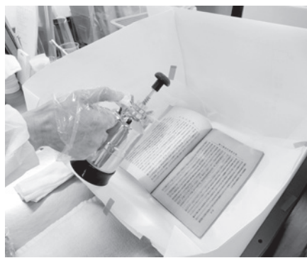
水酸化カルシウムによる浸漬脱酸法(上)と酸化マグネシウムによる噴霧脱酸法(下)
